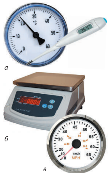
Рис. 2.2. Сучасні прилади для прямого вимірювання температури (а); маси (б); швидкості руху (в)
