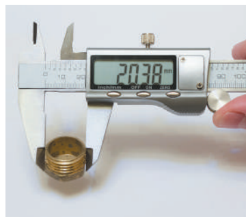
Рис. 2.3. Штангенциркуль. Точність вимірювання зображеним приладом — соті частки міліметра
