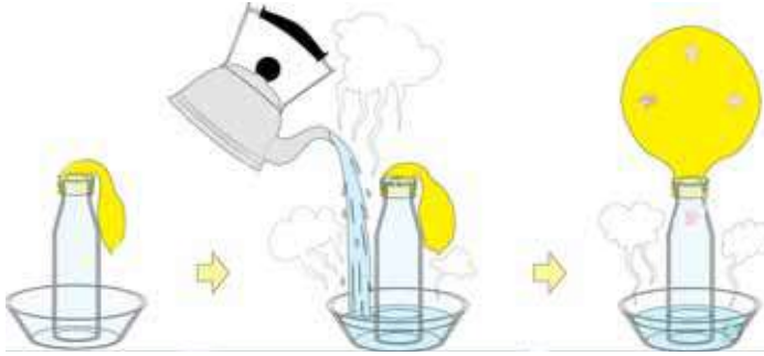
Мал. 25.1. Розширення і стискання повітря залежно від зміни температури
