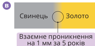
Мал. 6.4. Дифузія: а) у рідині; б) в газах; в) у твердих тілах
